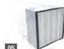
05 HEPA Filter H14 (Option -H) สามารถกรองเชื้อโรค และอนุภาคขนาดเล็ก 0.3 ไมครอนได้ มากกว่า 99.995% ตามมาตรฐาน EN-1822
