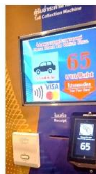
ช่องเก็บค่าผ่านทางแบบ EMV Toll Collection Machine (TCM)
