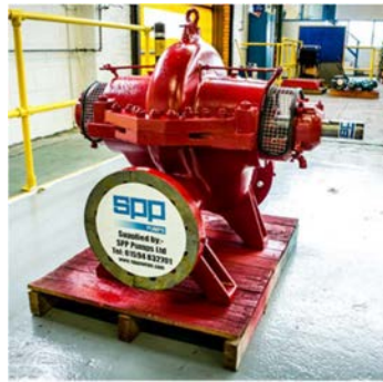
ปั๊มสูบน้ำดับเพลิง (Fire Pump)
