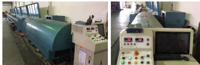
เครื่องทดสอบแรงดึง 400 ตัน
