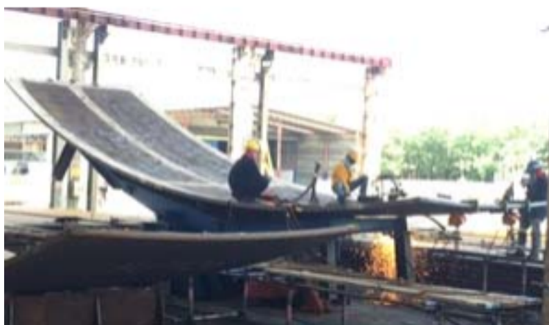
งานตัดขึ้นรูปเหล็กแผ่น
