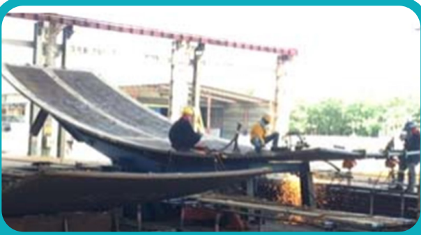
งานดัดขึ้นรูปเหล็กแผ่น
