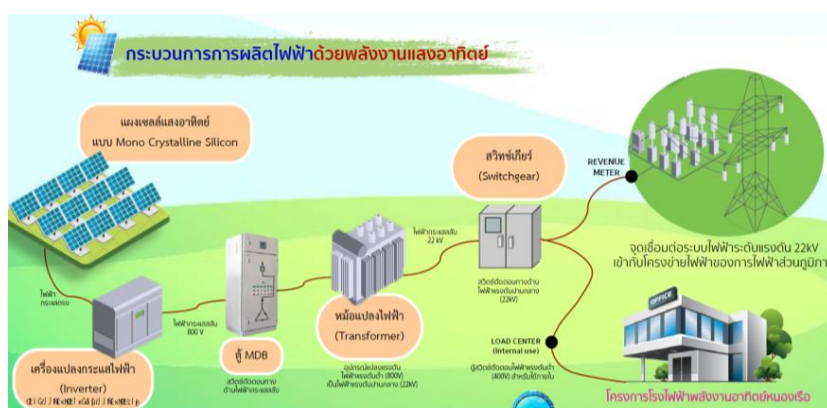
ตัวอย่างกระบวนการผลิตไฟฟ้าจากโครงการโรงไฟฟ้าพลังงานแสงอาทิตย์
