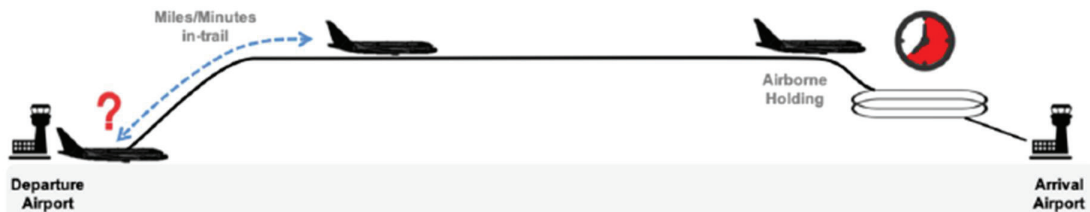
ภาพแสดงการบริหารจัดการปริมาณการจราจรทางอากาศแบบ Air Traffic Flow and Capacity Management (มีการกำหนดเวลาวิ่งขึ้น (CTOT) จากสนามบินต้นทาง)
