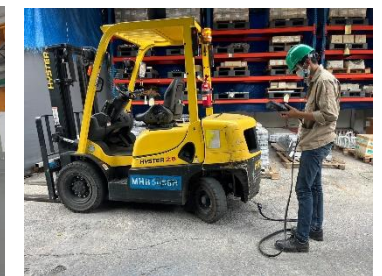
ภาพการตรวจวัดปล่อยระบายอากาศ และการตรวจวัดเขม่าควันรถโฟล์คลิฟท์
