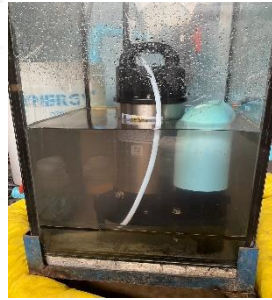
ภาพการทดลองการใช้ออกซิเจนบำบัดน้ำเสีย เพื่อเพื่อประสิทธิภาพของระบบบำบัดน้ำเสียและการนำน้ำกลับมาใช้ซ้ำ
