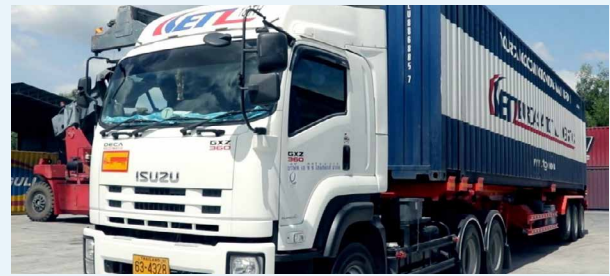
รถลากจูง (Prime Mover) และรถกึ่งพ่วง (Semi-trailer) ที่บรรทุกตู้คอนเทนเนอร์แบบมาตรฐาน (Dry Container)
