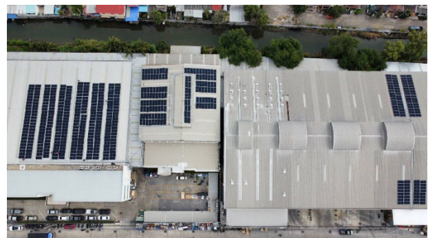
การติดตั้งระบบผลิตไฟฟ้าพลังงานแสงอาทิตย์บนหลังคา (Solar Rooftop)
