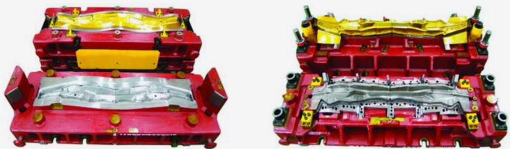
ตัวอย่างของ Single Die ที่ดำเนินการออกแบบและสร้างโดย TATP
