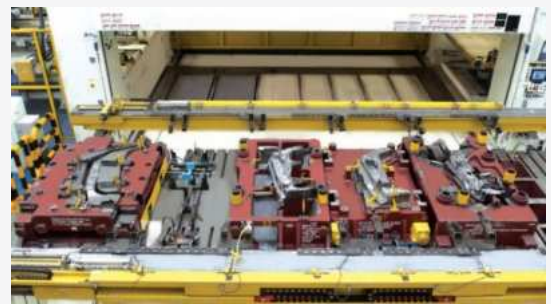
ตัวอย่างของ Transfer Die ที่ดำเนินการออกแบบและสร้างโดย TATP
