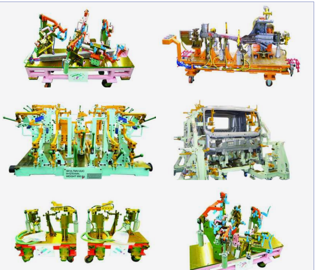
ตัวอย่าง Assembly Jigs ที่ TATP ได้ออกแบบและสร้างให้แก่ลูกค้า
