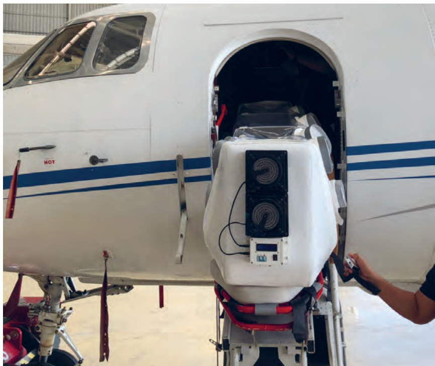
แคปซูลความดันลบสำหรับเคลื่อนย้ายผู้ป่วยทางอากาศ
