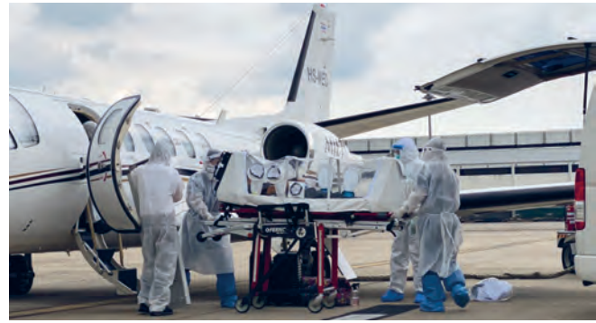
แคปซูลความดันลบสำหรับเคลื่อนย้ายผู้ป่วยทางอากาศ
