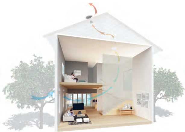
ระบบถ่ายเทอากาศในบ้าน (SCG Active Airflow™ System)
