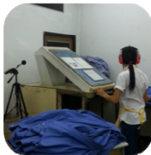
การตรวจวัดระดับความดังเสียง ผลการตรวจวัด 76 เดซิเบล เอ ผ่านเกณฑ์
