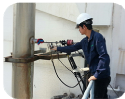
การตรวจปล่องระบายอากาศของ Boiler ผลการตรวจค่าความทึบแสง ร้อยละ 3.8 อยู่ในเกณฑ์มาตรฐาน
