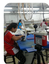
การตรวจวัดระดับความร้อน ผลการตรวจวัด 29.1 °C ผ่านเกณฑ์ มาตรฐาน
