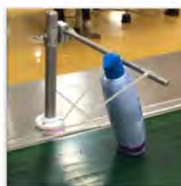
หลังการปรับปรุง ออกแบบจิ๊กเพื่อใช้แทนการจัดวาง
