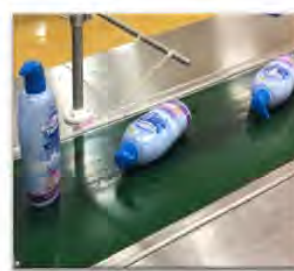
หลังการปรับปรุง ออกแบบจิ๊กเพื่อใช้แทนการจัดวาง
