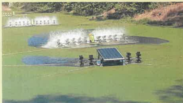
กังหันเติมอากาศขนาด 10 ใบพัด และ กังหันเติมอากาศแบบโซล่าเซลล์
