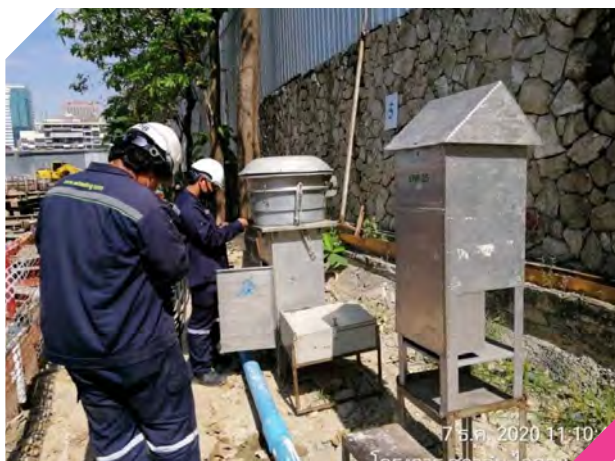
การวัดค่าฝุ่นละออง สำหรับการตรวจวัดประจำเดือน เพื่อควบคุมดูแลไม่ให้ค่าฝุ่นเกินค่ามาตรฐาน
