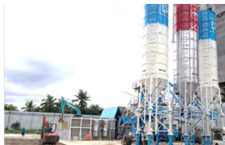
ตั้งโรงผลิตคอนกรีตชั่วคราวภายในโครงการ เพื่อช่วยลดมลพิษที่เกิดจากการขนส่ง
