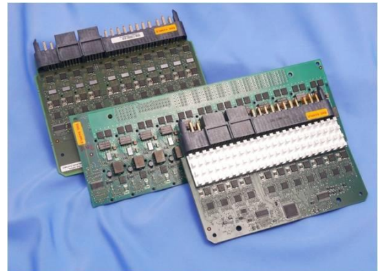
อุปกรณ์ควบคุมแรงดันไฟฟ้าแบบโมดูล ขนาด 12V/0.9V ในรูปแบบต่างๆ
