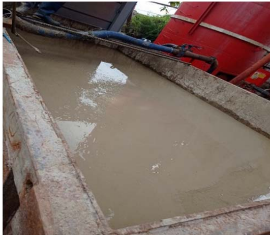
ภาพที่ 1 ก) น้ำโคลนขุดเจาะ (Bentonite) ที่เสื่อมสภาพ ข) เครื่องแยกตะกอนแบบแรงเหวี่ยงหนีศูนย์กลาง (Decanter centrifuge)
