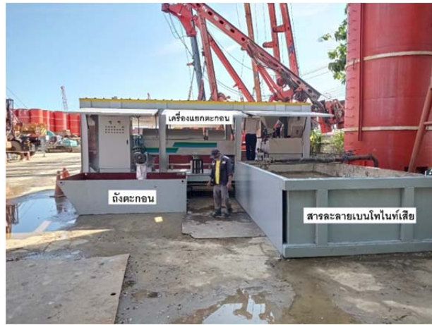
ภาพที่ 1 ก) น้ำโคลนขุดเจาะ (Bentonite) ที่เสื่อมสภาพ ข) เครื่องแยกตะกอนแบบแรงเหวี่ยงหนีศูนย์กลาง (Decanter centrifuge)
