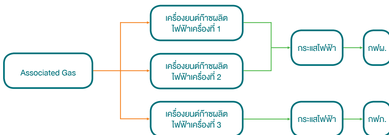
แผนผังแสดงภาพรวมของกระบวนการผลิตของโรงไฟฟ้าประดู่เฒ่า-เอ
