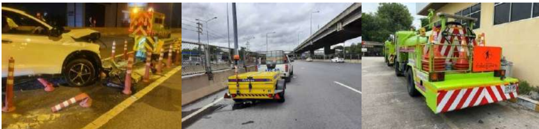
งานลดความรุนแรงจากอุบัติเหตุ: อุปกรณ์ดูดซับแรงกระแทกหัวเกาะ (Crash Cushion) อุปกรณ์ดูดซับแรงกระแทกท้ายรถบรรทุก (Truck Mounted Attenuator)
