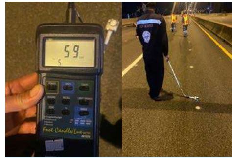
การตรวจสอบค่าความสว่างบนสายทาง
