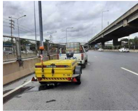
การตรวจสอบความฝืดผิวทาง (International Friction Index: IFI) Skid Resistance Tester ด้วยวิธี Fixed Slip Method
