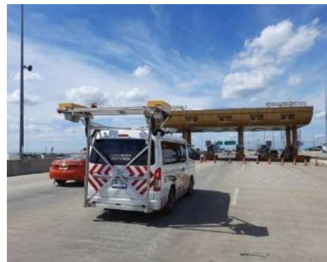
การตรวจสอบผิวจราจร: ตรวจวัดค่าความขรุขระ (International Roughness Index: IRI) และร่องล้อ
