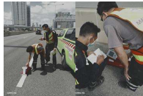
ตรวจสอบค่าการสะท้อนแสงเส้นการจราจร
