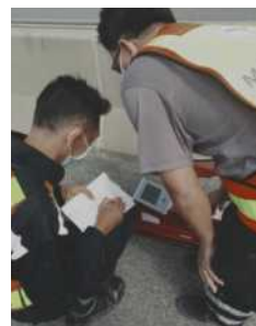
ตรวจสอบค่าการสะท้อนแสงเส้นการจราจร
