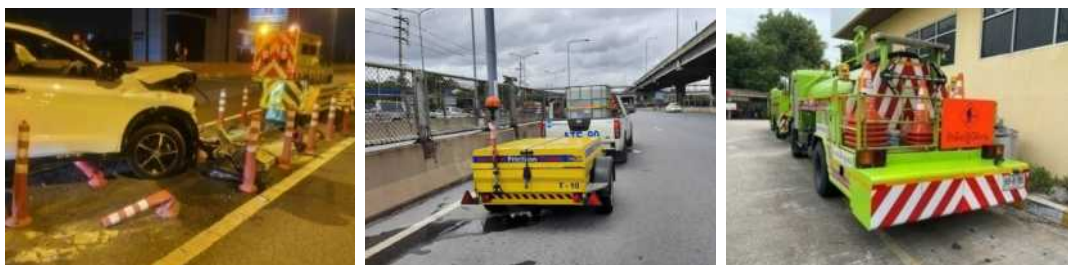
งานลดความรุนแรงจากอุบัติเหตุ: อุปกรณ์ดูดซับแรงกระแทกหัวกระแทก (Crash Cushion) อุปกรณ์ดูดซับแรงกระแทกท้ายรถบรรทุก (Truck Mounted Attenuator)
