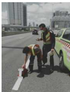
ตรวจสอบค่าการสะท้อนแสงเส้นการจราจร
