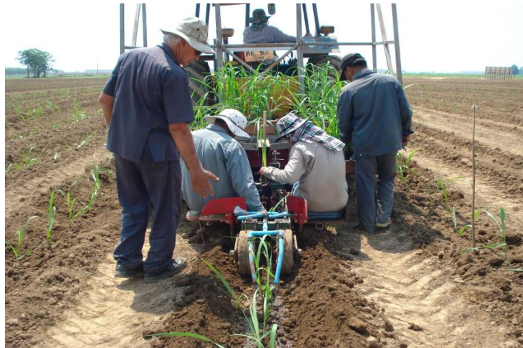
ภาพ: เครื่องปลูกอ้อยแบบ Shute Planter
