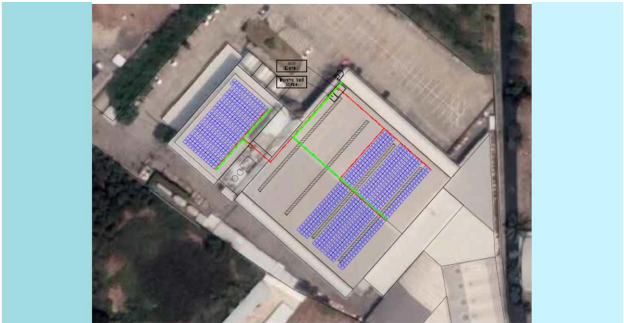
รูปแสดงแบบการติดตั้งแผงโซล่าเซลล์
