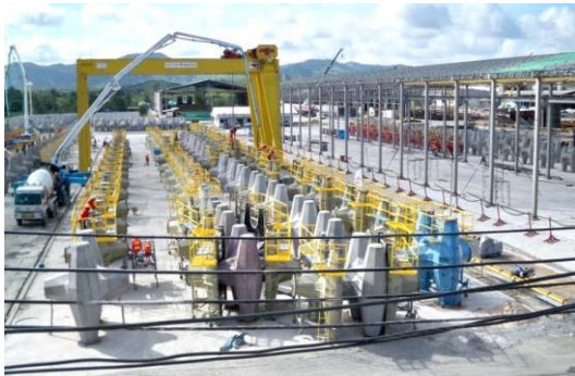
ชิ้นส่วนเชื่อมกันชายฝั่งจากคลื่นทะเล (Breakwater)
