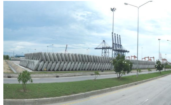
ชิ้นส่วนเชื่อมกันชายฝั่งจากคลื่นทะเล (Breakwater)
