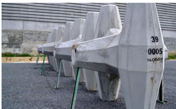
ชิ้นส่วนเชื่อมกันชายฝั่งจากคลื่นทะเล (Breakwater) โครงการ Sino Iron Cape Preston Breakwater ประเทศออสเตรเลีย
