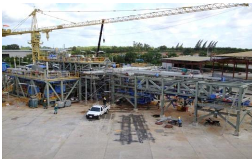
งานแปรรูปและประกอบกลุ่มชิ้นงานขนาดใหญ่ – อุตสาหกรรมก๊าซ โครงการ APLNG – Pre Assemble Unit ประเทศออสเตรเลีย
