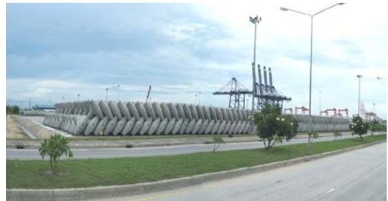
ชิ้นส่วนเชื่อมกันชายฝั่งจากคลื่นทะเล (Breakwater) โครงการ Sino Iron Cape Preston Breakwater ประเทศออสเตรเลีย
