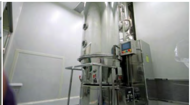
▲ การอบแห้งโดยใช้อุปกรณ์ fluid bed dryer
