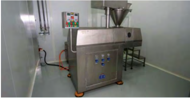
▲ เครื่องตอกเม็ดสำหรับแกรนูลแบบแห้ง
