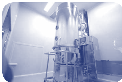
การอบแห้งโดยใช้อุปกรณ์ fluid bed dryer
