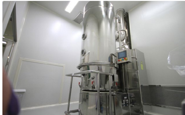
การอบแห้งโดยใช้อุปกรณ์ fluid bed dryer
