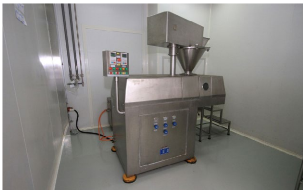
เครื่องตอกเม็ดสำหรับแกรนูลแบบแห้ง
