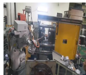
ภาพโรบอทที่ติดตั้ง 2 จุดในสายการผลิตแผนกฉีดอลูมิเนียม
