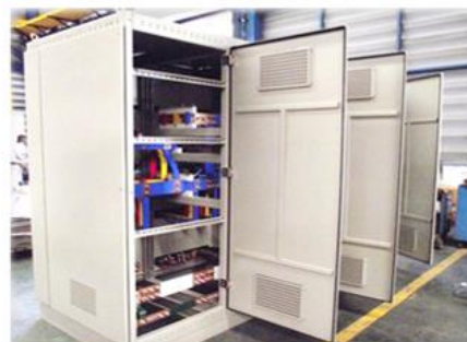
ภาพตู้สวิตช์บอร์ด (Main Distribution Board : MDB)
