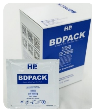
อุปกรณ์สำหรับตรวจสอบประสิทธิภาพในการไล่อากาศ และการรั่วไหลของอากาศ ( Bowie-dick type Test Pack )
