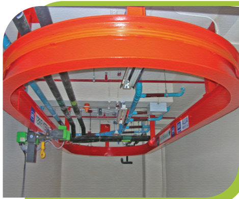
เครนรางเลื่อนไฟฟ้าแบบรางเดี่ยว
