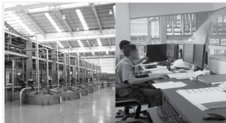
การส่งผ่านวัตถุดิบไปทำการผลิต โดยผ่านระบบท่อ ควบคุมด้วยระบบอัตโนมัติ
