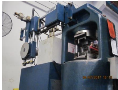
ภาพตัวอย่างเครื่องอัดปลอกขนาด 2,000 ตัน
