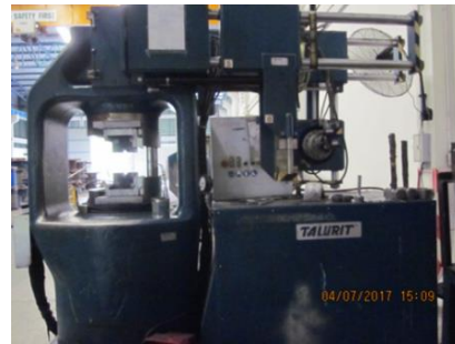
ภาพตัวอย่างเครื่องอัดปลอกขนาด 2,000 ตัน
