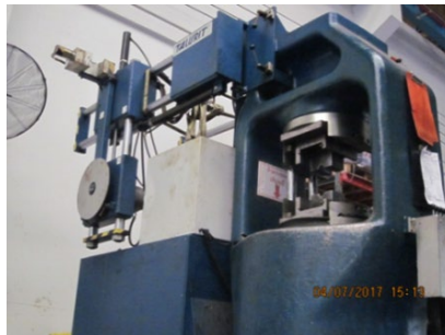
ภาพตัวอย่างเครื่องอัดบล็อกขนาด 2,000 ตัน
