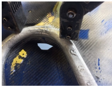
ภาพตัวอย่างการตรวจสอบแบบ NDT ด้วยวิธีการสนามแม่เหล็ก (ภาพซ้าย) และอุปกรณ์ที่ใช้ (ภาพขวา)
