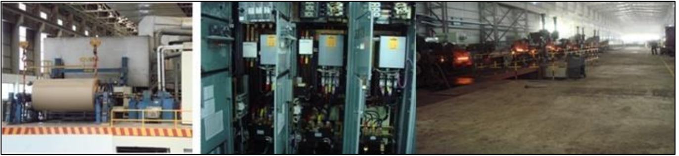
ภาพแสดงการเปลี่ยนระบบการควบคุมเครื่องจักรเก่าโดยการเปลี่ยนเป็น Digital Drives พร้อมระบบ PLC และระบบรายงานผลจากคอมพิวเตอร์
