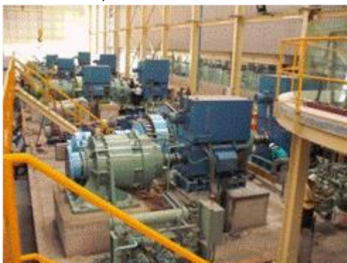
ภาพแสดงระบบควบคุมความเร็วพร้อม Motor ขนาด 1,500 kW. และ 630 kW. พร้อมระบบ PLC และการสื่อสารกับระบบรายงานผลจากคอมพิวเตอร์
