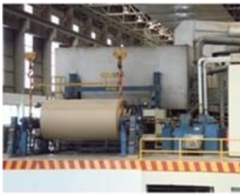
ภาพแสดงการเปลี่ยนระบบการควบคุมเครื่องจักรเก่าโดยการเปลี่ยนเป็น Digital Drives พร้อมระบบ PLC
