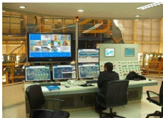
ภาพแสดงระบบควบคุมความเร็วพร้อม Motor ขนาด 1,500 kW. และ 630 kW. พร้อมระบบ PLC และการสื่อสารกับระบบรายงานผลจากคอมพิวเตอร์
