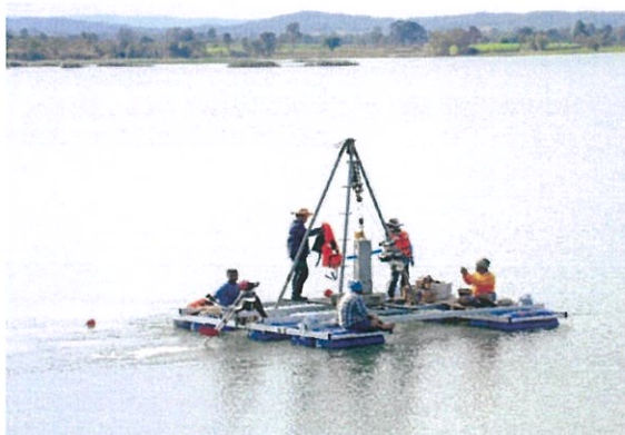
ภาพถ่ายอย่าง : การติดตั้ง Water Level ในอ่างเก็บน้ำ
