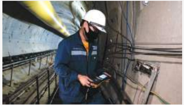
เครื่องมือ Total Pressure Cell Monitoring in Tunnel
