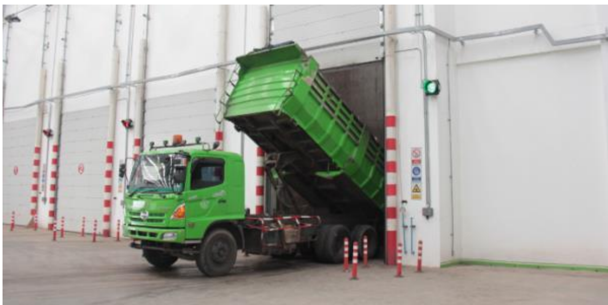
การนำขยะเข้าสู่เตาเผาไหม้ โดยเป็นระบบปิดของโรงไฟฟ้า MSW ขอนแก่น (อำเภอเมือง จังหวัดขอนแก่น)
